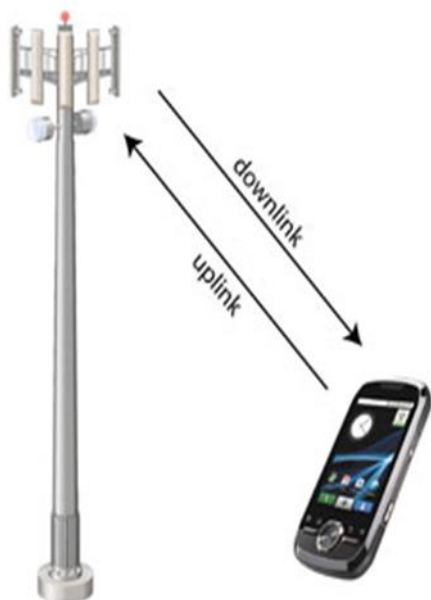
Figur 7: Dubbelriktad kommunikation mellan mobiltelefon och basstation.
